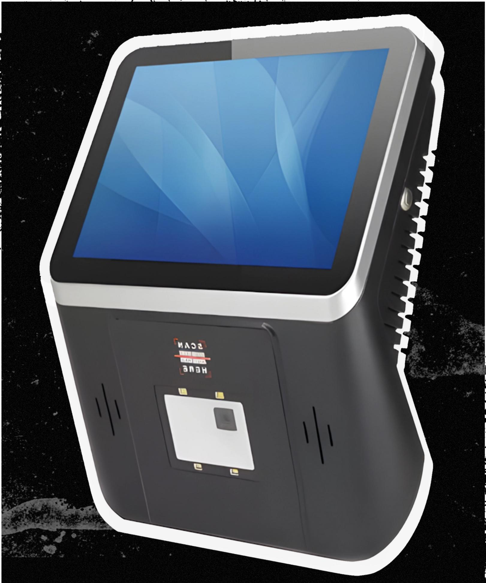
**Der quickCHECK A100 ist ein Gerät, das sich ideal für große Geschäfte eignet.** Seine Hauptfunktion besteht darin, Produktcodes zu scannen und Name und Preis auf dem Bildschirm anzuzeigen. **Der Preisscanner verfügt über einen integrierten Scanner mit einem CMOS-Sensor, der das Lesen von 1D-Barcodes und 2D-Codes wie QR-Codes ermöglicht.** **Das Android-System** vereinfacht die Bedienung erheblich.
