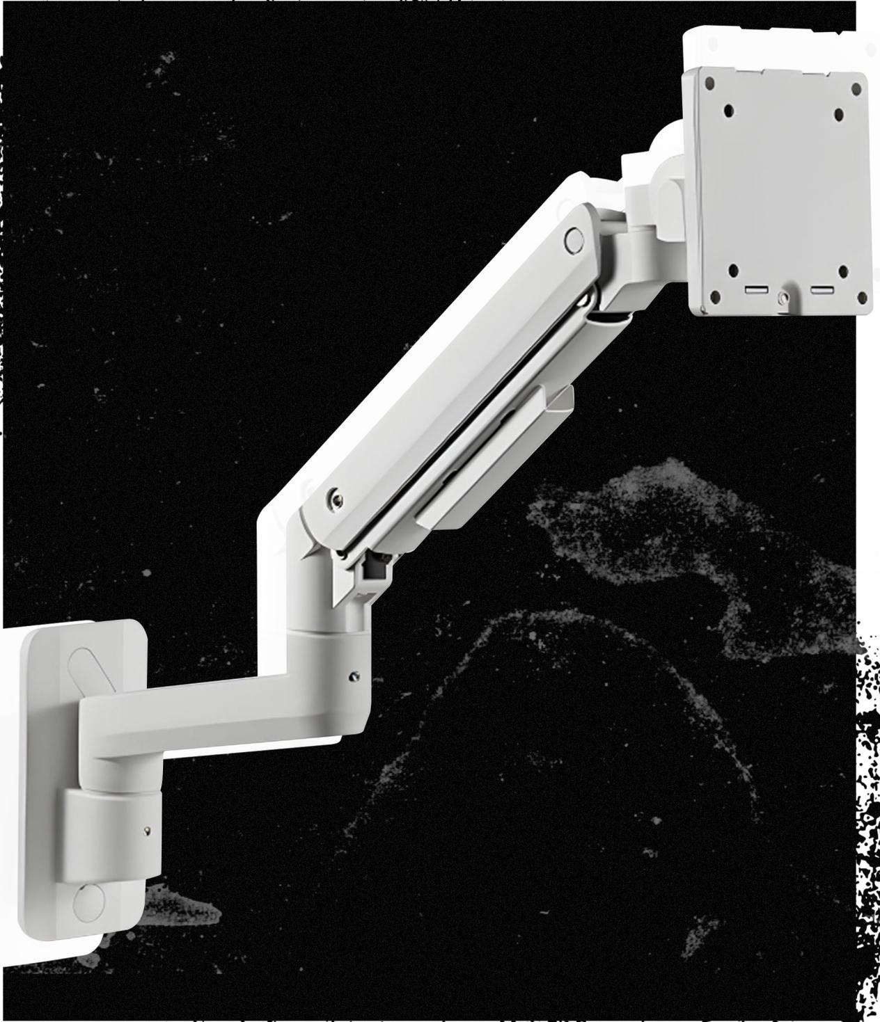
**SolidHand BGW01W ist eine robuste Wandhalterung für einen einzelnen Monitor mit einem Gewicht von bis zu 20kg und einer Größe von 17 bis 49Zoll, kompatibel mit dem VESA-Standard 75x75 oder 100x100. Ausgestattet mit einer Gasfeder ermöglicht sie eine einfache Höhenverstellung, eine Drehung des Monitors um 180° sowie das Einstellen des Bildschirms im Hochformat.**
