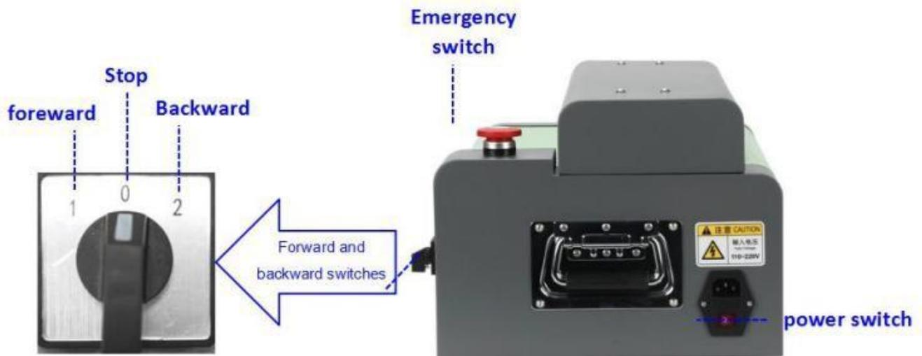
3. Schalten Sie den Netzschalter ein und drehen Sie die Vorwärts- und Rückwärtsschalter in die Position "1" (Vorwärtsdrehungsposition)
