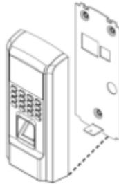
Passen Sie die in die Wand gebohrten Löcher an und befestigen Sie die hintere Abdeckung mit Schrauben an der Wand.
