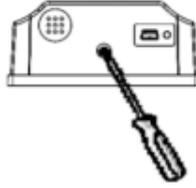
Entfernen Sie die hintere Abdeckung des Geräts.
