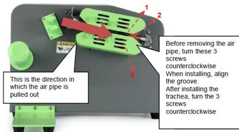
2. Wenn Sie die Klinge zerlegen, lösen Sie die Schraube, indem Sie sie gegen den Uhrzeigersinn drehen. Ziehen Sie bei der Montage der Klinge die Schraube durch Drehen im Uhrzeigersinn fest. Auf dem Luftschlauch ist Platz für das Sitzen der Klinge, was die korrekte Positionierung gewährleistet.
